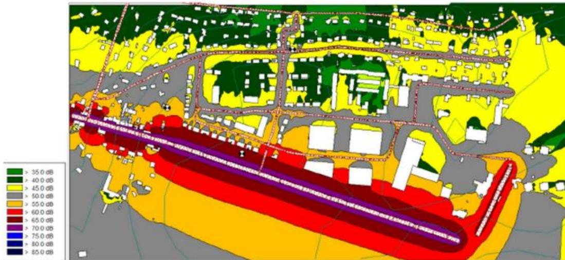
Figure 3 : Cartographie sonore du projet (sans solution acoustique)
